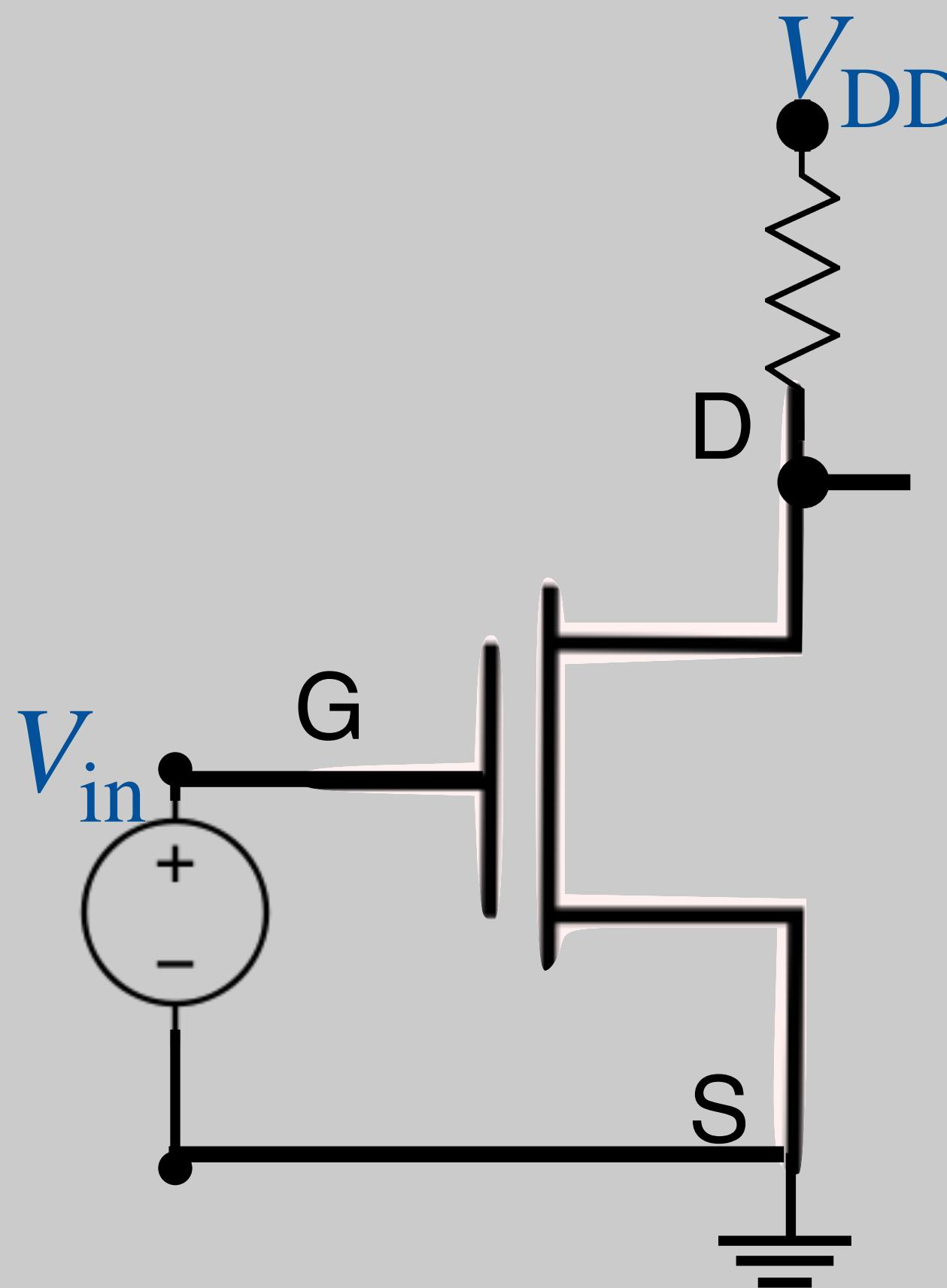
$$V_{GS} \geq V_{t_n}$$
