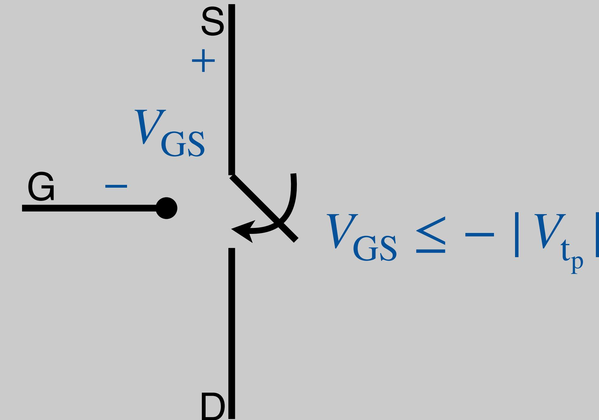
$$V_{GS} \leq -|V_{t_p}|$$
