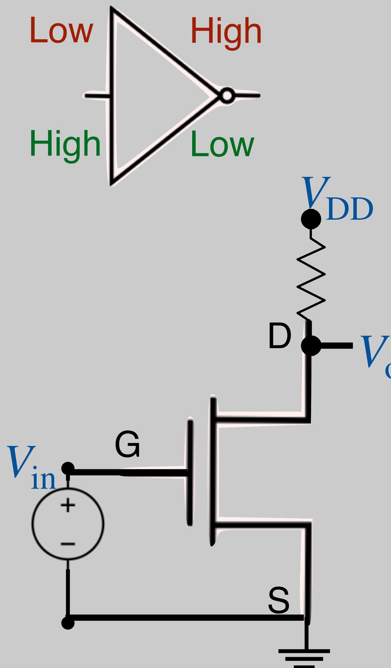
$$V_{GS} < V_{t_n}$$
