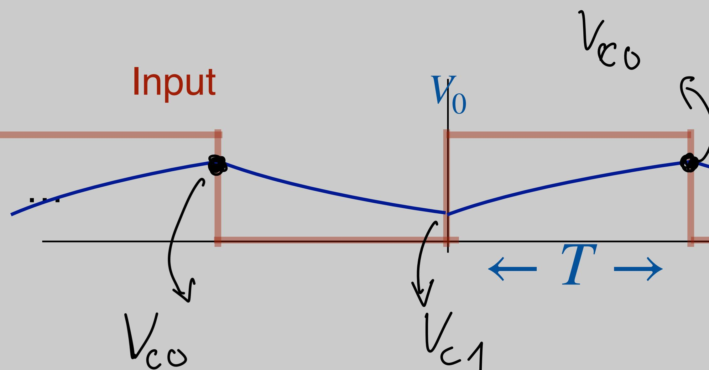
$$\textcircled{1} \quad V_{c1} = V_{c0} e^{-\frac{T}{RC}}$$
