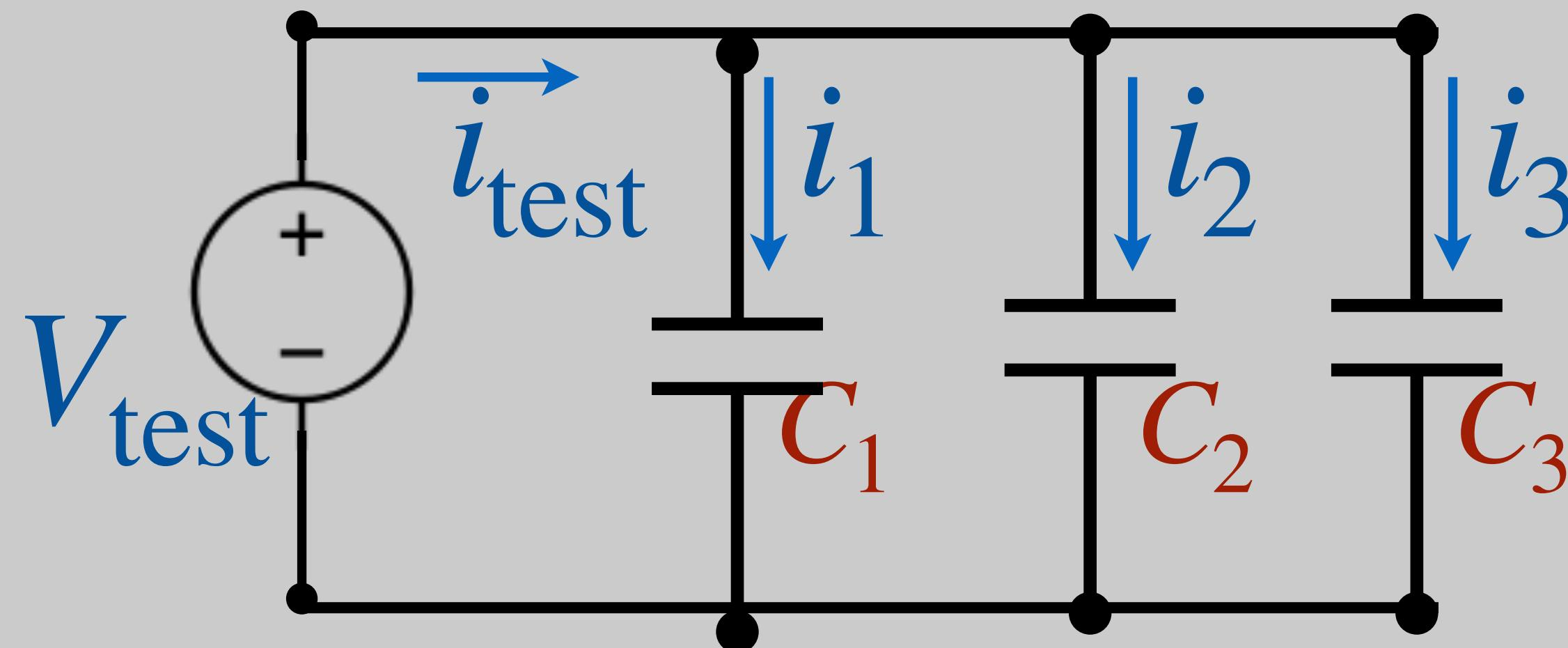
$$\dot{i}_{\text{test}} = i_1 + i_2 + i_3$$
