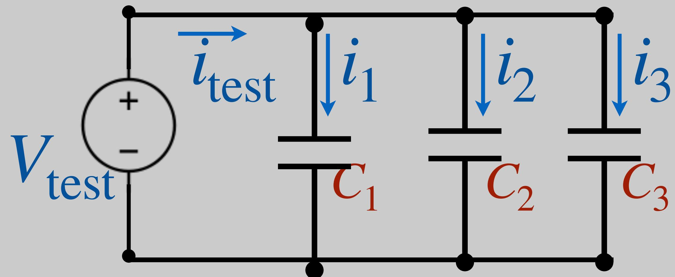
$$\dot{i}_{\text{test}} = i_1 + i_2 + i_3$$
