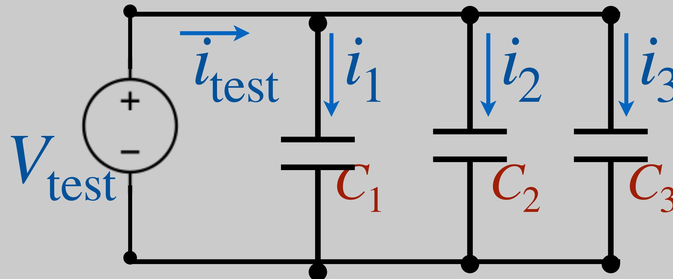
$$i_{\text{test}} = i_1 + i_2 + i_3$$
